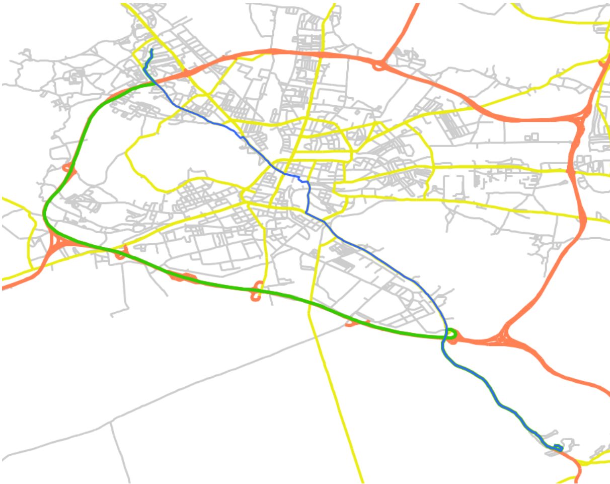
Slika 9.2: Rezultat usmerjanja iz Škofljice v Ljubljana-Dravljje. Pot "hitrost" (zelena črta) nas pripelje po avtocesti, medtem ko pot "dolžina" (modra črta) vodi skozi center Ljubljane. Na začetku in na koncu se poti prekrivata. Utež h(n) je bila v obeh primerih 1,2. Na sliki so lepo vidni nivoji cest. Ceste najvišjega nivoja so oranžne, srednjega rumene in najnižjega sive. V primeru poti "hitrost" to pomeni, da so oranžne črte najcenejše (najhitrejše), sive pa najdražje (najpočasnejše).
